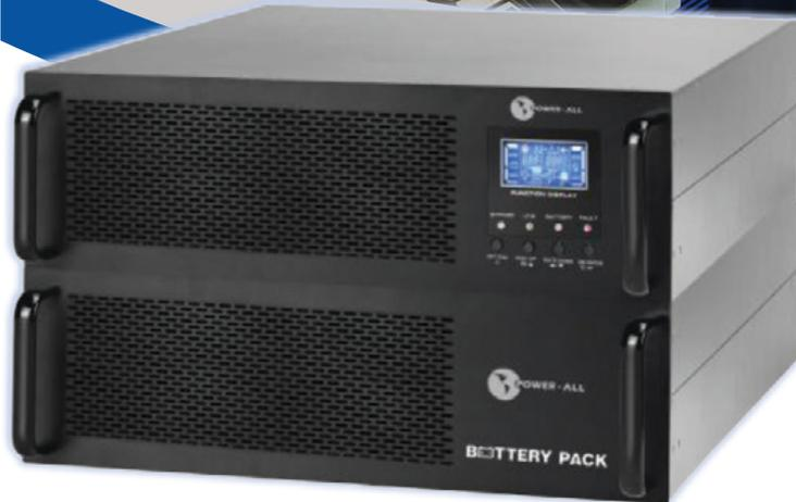
Es un UPS de configuración Rack Mount con tecnología On-line Doble Conversión, sin transformador. Utiliza IGBT's y diodos de alta velocidad, en inversor y rectificador, lo cual significa bajo THD de entrada y FP superior a 0.9 además de interruptor giratorio de bypass de mantenimiento.
